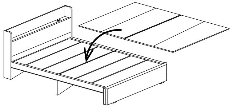
床板を乗せる前に全ての箇所がのボルト・ネジがしっかりと締まっているか確認してから乗せて下さい。
