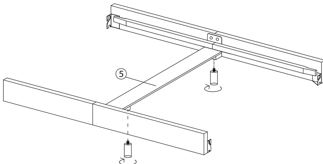
④ サイドフレームに⑥トップ・フットボードと脚部を取り付けます。(Aボルト・Dナット使用)
