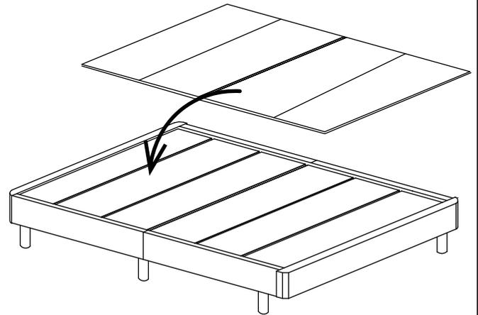
床板を乗せる前に全ての箇所がのボルト・ネジがしっかりと締まっているか確認してから乗せて下さい。
